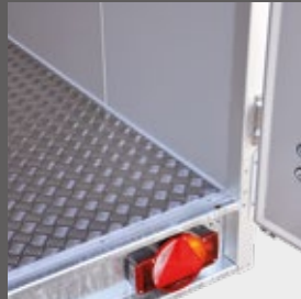
Bodenplatte mit Alu-Riffelblech belegt
