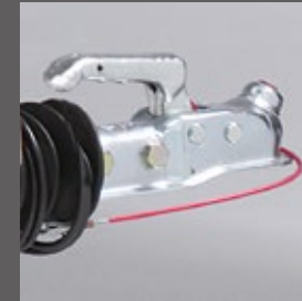
Kugelkopfkupplung für höhenverstellbare Zugdeichsel
