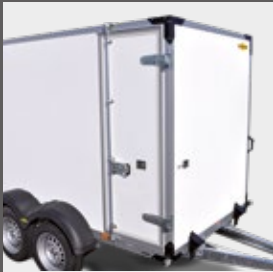
Seitentür mit Drehstangenverschluss von Innenhöhe 1500 - 2300 mm
