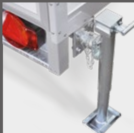
Teleskopkurbelstützen für Kofferanhängler (2 Stück)
