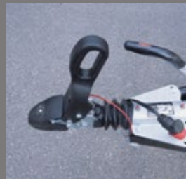
Sicherheitskupplung mit Spurstabilisierung
