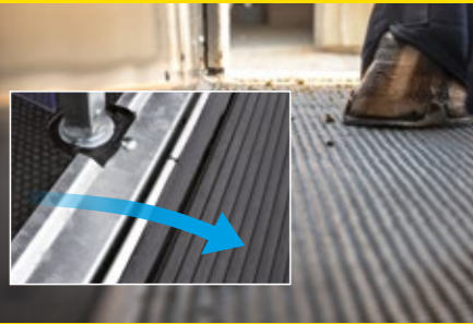
Das geringe Spaltmaß der Heckklappe vermeidet Fehlritte des Pferdes.
