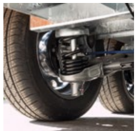
Das EquiDrive® PLUS 5 Schraubenfederfahrwerk
