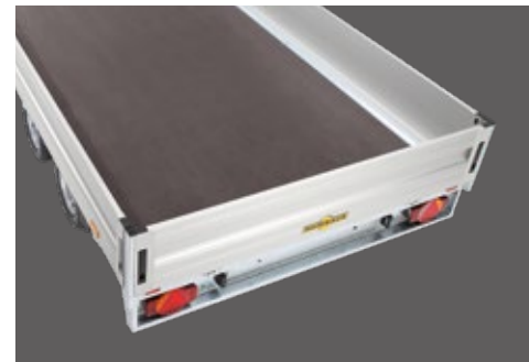
Bis Innenmaß 5220 x 2070 mm Bodenplatte aus einem Stück
