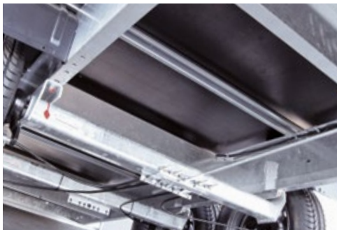
Rahmen und Fahrgestell Tauchbad feuerverzinkt
