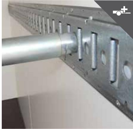
Ankerschiene für Sperrstange
