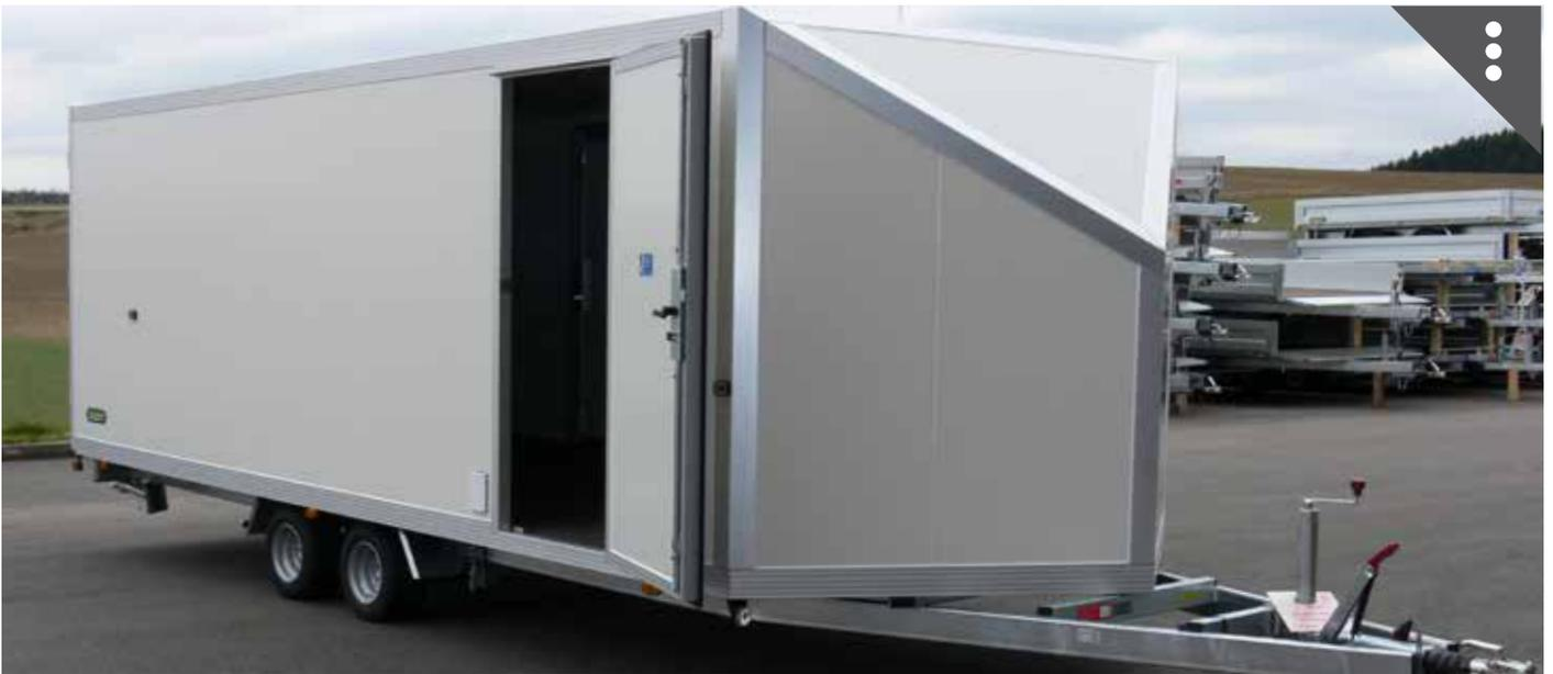
Stirnwand spitz zulaufend mit abgeschrägtem Dach
