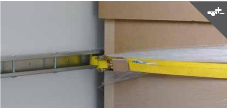
Stäbchenzurrschiene für Spanngurte und Sperrstangen
