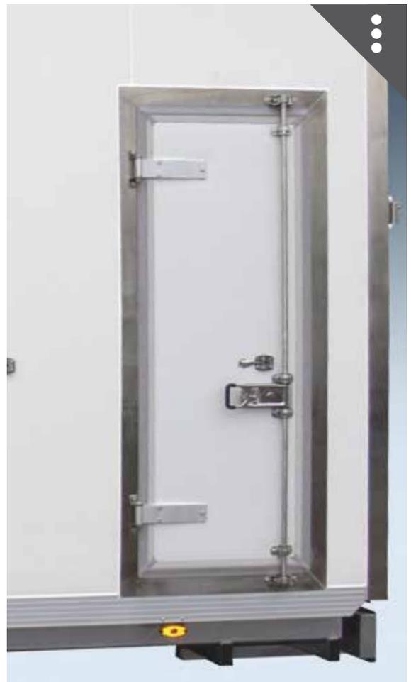
Seitentüre mit Drehstangenverschluss
