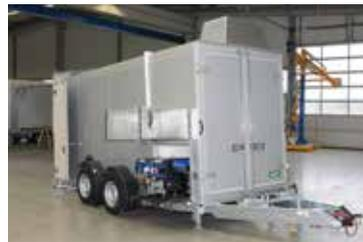
Robuster Kofferaufbau aus Sandwich-Paneelen
