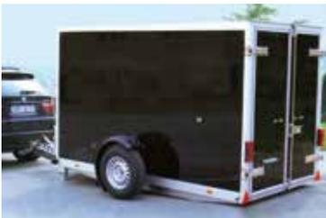
Anhänger in an- und abgehängtem Zustand absenkbar
