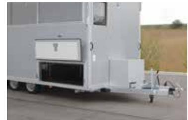
Verschweißtes Längsträgerfahrgestell besonders stabil und langlebig
