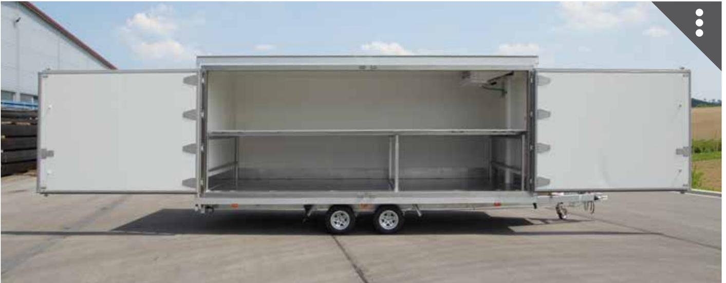
2 Ebenen mit Kühlfunktion, Seitentüre doppelflügelig, im Sonderbau auch über die gesamte Seitenlänge möglich
