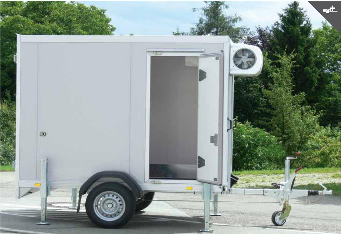
Seitentüre mit Drehstangenverschluss
