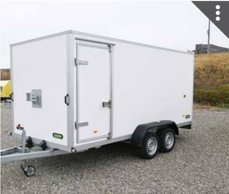
Seitentüre mit Drehstangenverschluss und Ersatzradhalter an der Stirnwand
