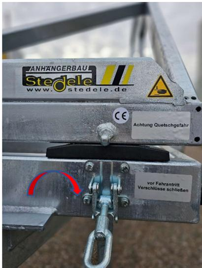
Der Exenterschluss ist mit einer Sicherung ausgestattet.
