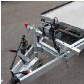
Verschweißter und feuerverzinkter Stahlrahmen
