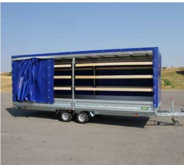
Planenaufbau mit Schiebepane in blau RAL 5002
