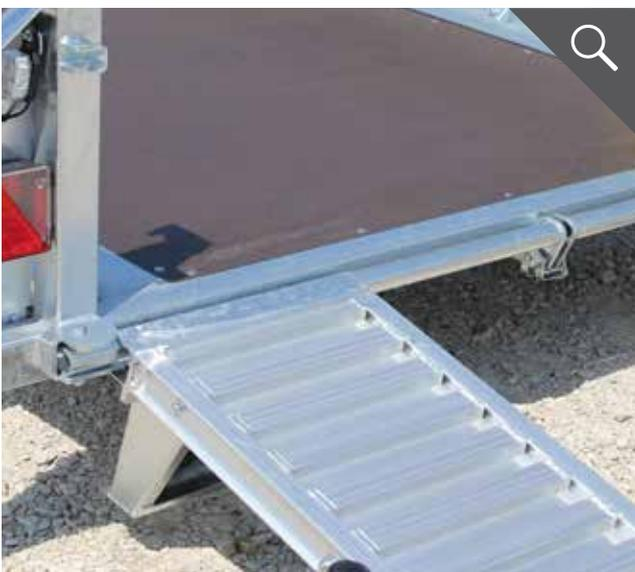
Auffahrrampen leicht zu verschieben für unterschiedliche Fahrzeugbreiten
