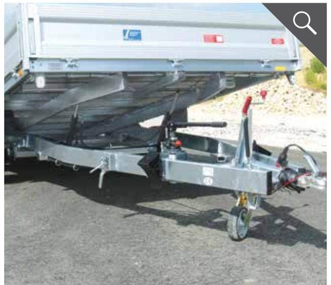
Verschweißter und feuerverzinkter Stahlrahmen
