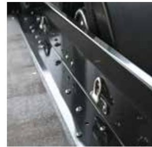
8-10 abklappbare Zurrösen mit bis zu 400 daN Zugkraft belastbar
