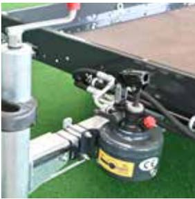
Handpumpe mit hydraulischer Absenkeinrichtung und Absenksicherung (bei gebremster Ausführung)
