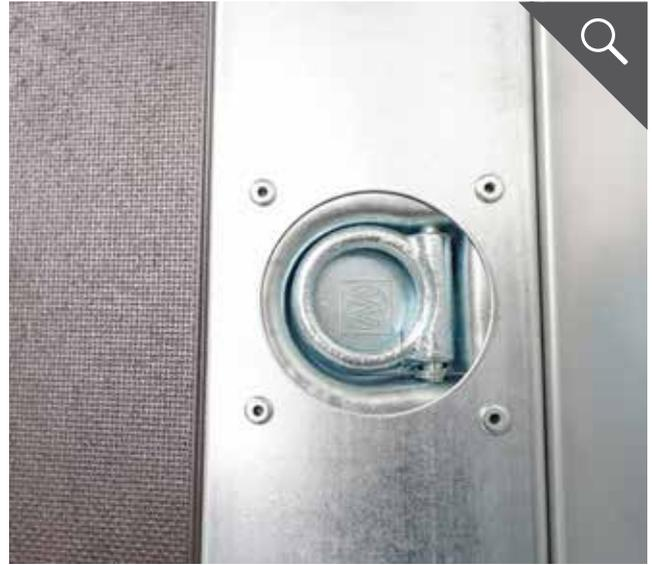
Zurrmulden versenkt im Bodenrahmenprofil, Dekra zertifiziert
