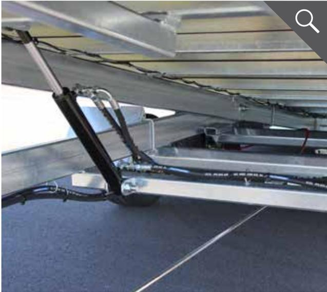
Doppeltwirkende Hydraulikzylinder für sicheres Beladen
