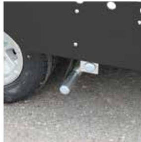
Einfache Entriegelung der Auffahrschienen durch Quickstop-Fußbetätigung
