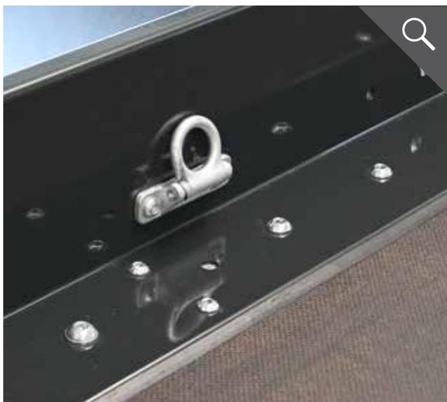
8-10 abklappbare Zurrösen mit bis zu 400 daN Zugkraft
