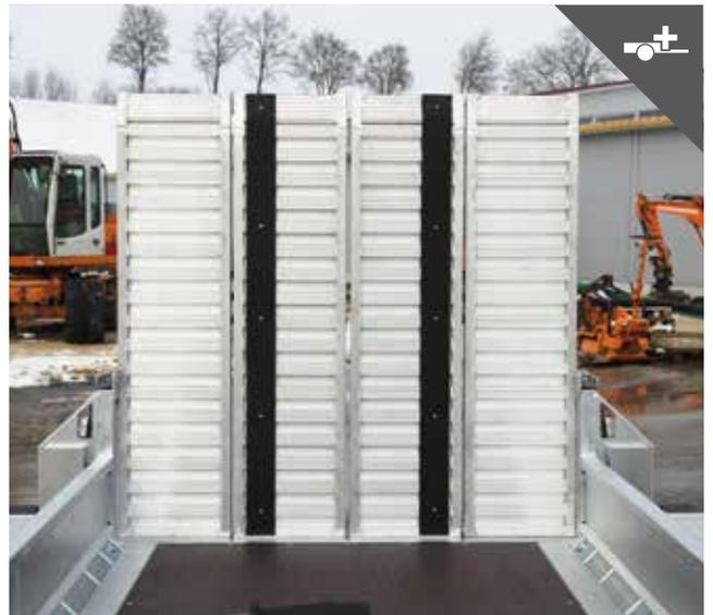
Gummiauflage für das Befahren mit Kettenfahrzeugen
