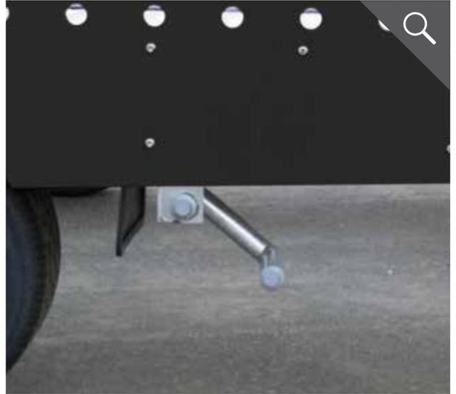
Quickstop-Fußbetätigung zum Entriegeln der Auffahrschienen
