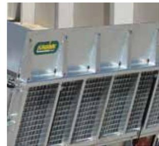
Durchgehende Stahlgitterauffahrklappe mit Alu-Riffelblech belegt
