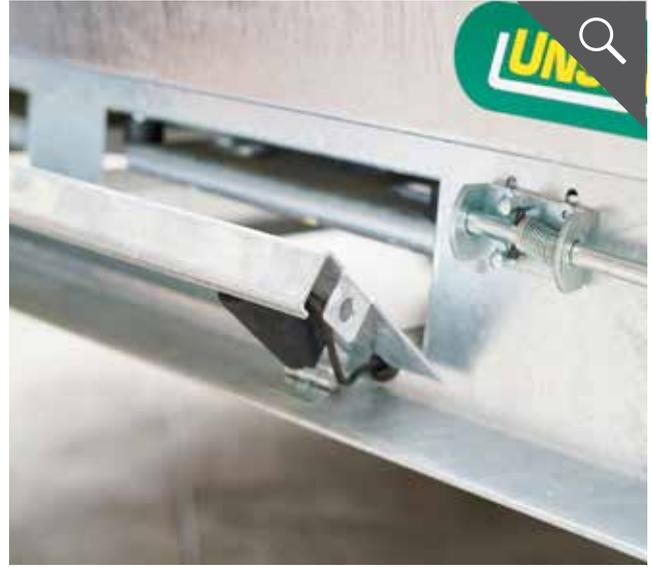
Abklappbarer Kennzeichenhalter zum eleganten Verstauen der Auffahrschienen
