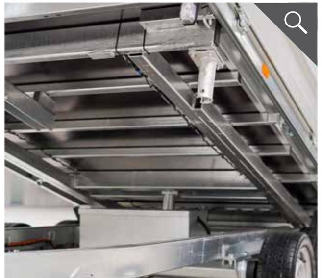
Verschweißter und feuerverzinkter Stahlrahmen
