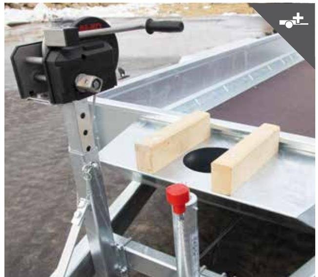
Baggerarmauflage, Windenbock mit Handseilwinde
