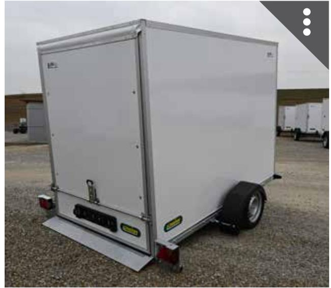
Absenkanhänger mit Kofferaufbau
