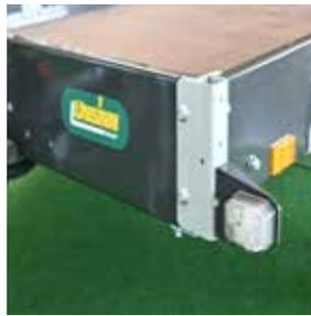
Aufbau 3-seitig aus Stahlprofil verzinkt und pulverbeschichtet in Schwarzgrau (RAL 7021)
