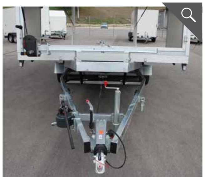
Fahrgestell aus verschweißter und feuerverzinkter Hohlprofilkonstruktion
