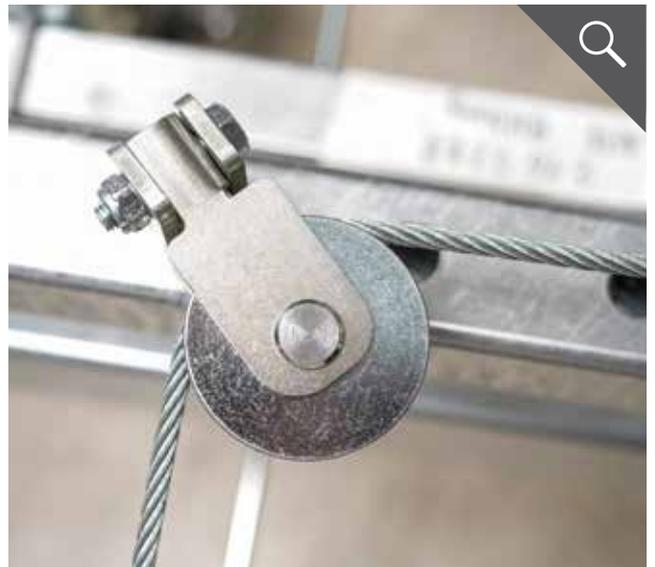
Umlenkrolle für optimale Seilführung
